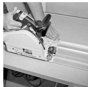
Bevor Sie mit der Montage beginnen, sollten Sie die Arbeitsplatten zusammenlegen und auf Passgenauigkeit überprüfen.
