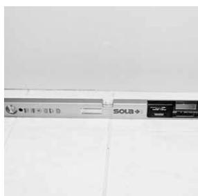
Bevor Sie mit der Montage beginnen, legen Sie eine Wasserwaage auf den Fußboden. Beginnen Sie am tiefsten Punkt des Raumes mit der Höhenausrichtung.
