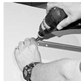
Achten Sie beim Bohren in die Wand unbedingt auf Stromkabel oder Wasserleitungen.
